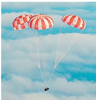
**Рис. 2.** Связка парашютов КСА «Орион»
