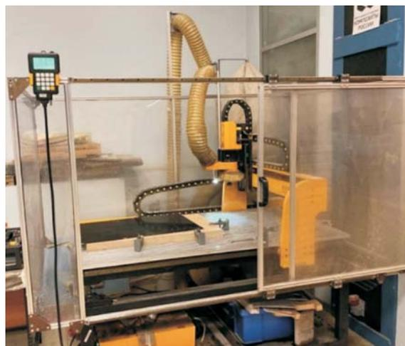
**Рис. 8.** Фрезерная машина, на которой вырезаны образцы УП
