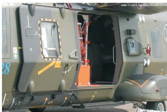
Рис. 3. Фюзеляж среднего вертолета, собранный из трехслойных панелей
