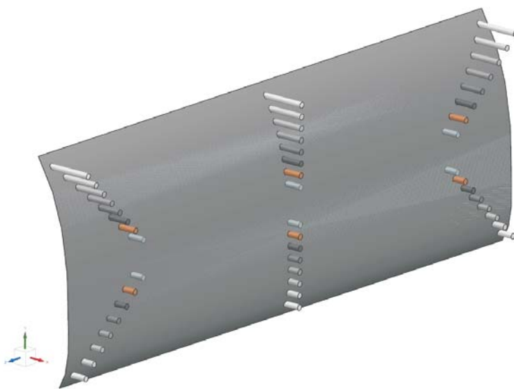
Рис. 4. Совмещенные варианты точек крепления рамы к панели
