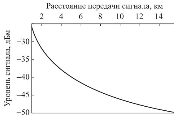
Рис. 2. Зависимость уровня сигнала от расстояния его передачи  $r$
