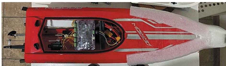
Рис. 6. Демпферные ленты, установленные в передней части корпуса катера
