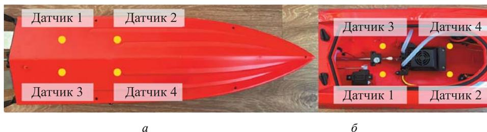
Рис. 5. Расположение тензорезисторов снаружи (а) и внутри (б)
