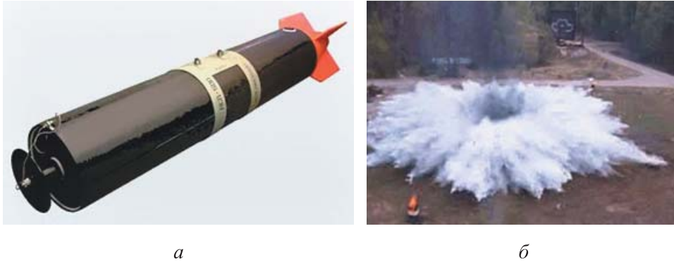
Рис. 1. Авиационное средство пожаротушения АСП-500:
