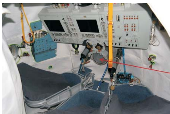
Рис. 8. Размещение выносного блока научной аппаратуры, регистрирующей излучение плазмы
