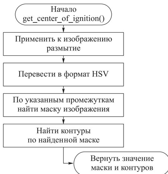
Рис. 10. Блок-схема подпрограммы, непосредственно определяющей очаг пожара на фото по цветовому диапазону
