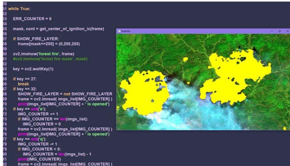
Рис. 12. Очаги пожара, обнаруженные программой на ИК-снимке и выделенные желтым цветом
