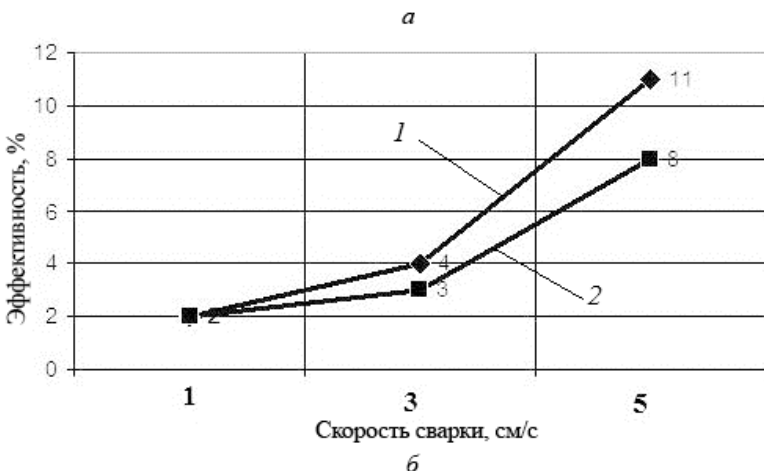
Рис. 3. Зависимости эффективности лазерного воздействия от скорости сварки для сталей X18H9 (1) и 30ХГСА (2)
