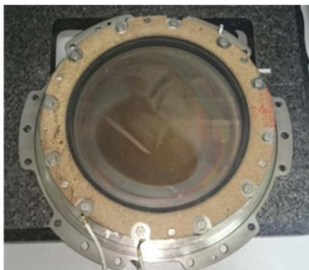
Рис. 1. Иллюминатор визира специального комплекса (ВСК4) ТПК «Союз» после возвращения на Землю со слоем отложений на поверхности
