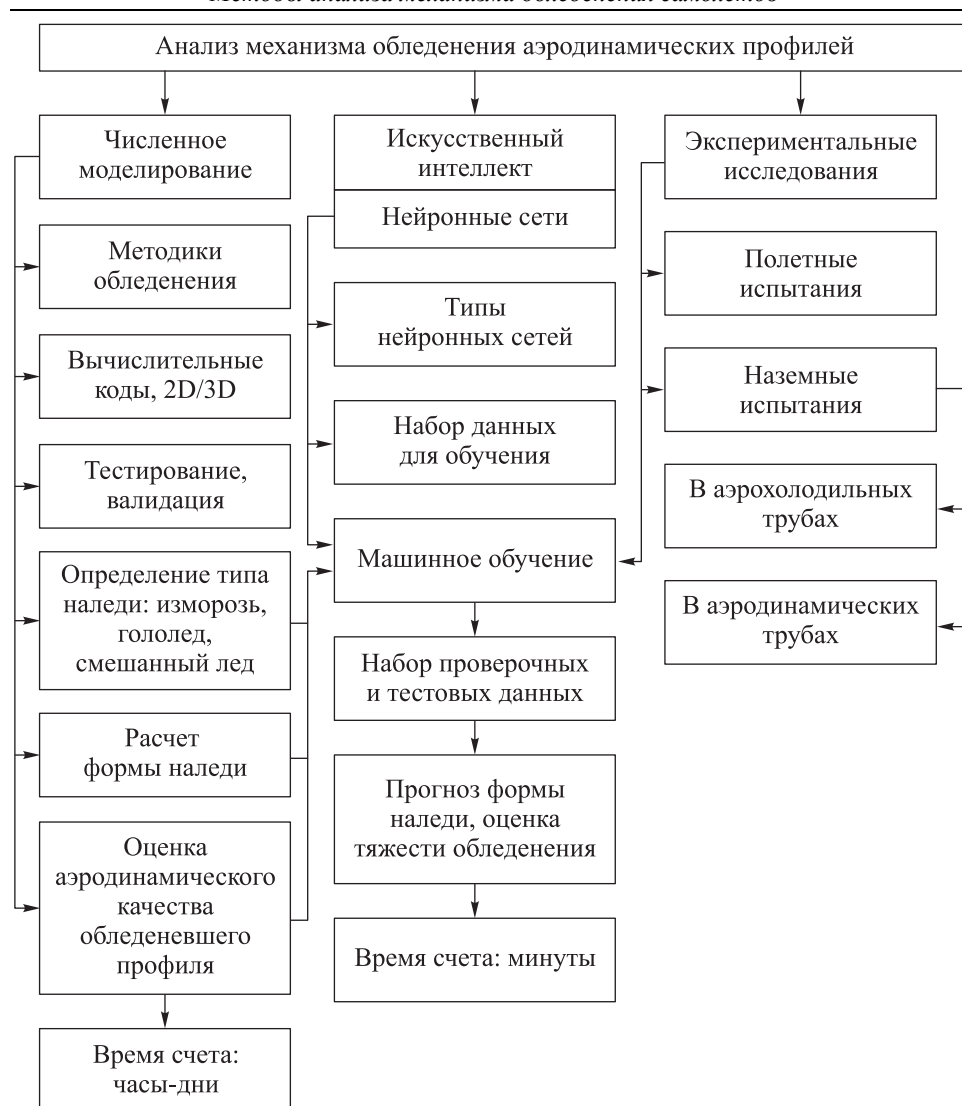
Рис. 1. Блок-схема методов анализа обледенения самолетов
