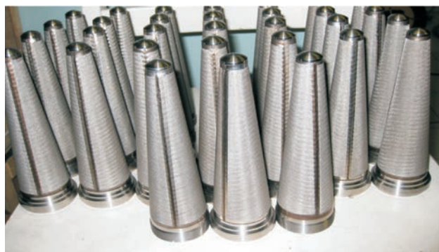
Рис. 5. Конические фильтры двустороннего действия из КПСМ для очистки жидкого кислорода и высококипящего компонента топлива с различными узлами соединения
