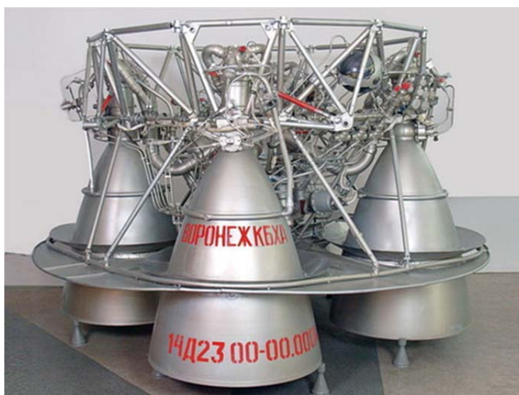
Рис. 1. Жидкостный ракетный двигатель, работающий на керосине и водороде
