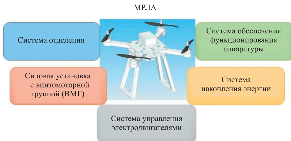
Рис. 5. Основные подсистемы мультироторного летательного аппарата
