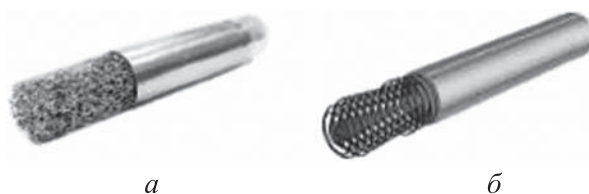
Рис. 1. Экспериментальная (а) и численная (б) модели цилиндра с пористой передней вставкой
