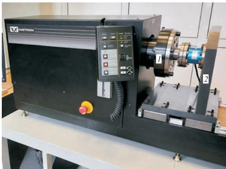
**Рис. 3.** Общий вид испытательной машины с установленной моделью муфты:
