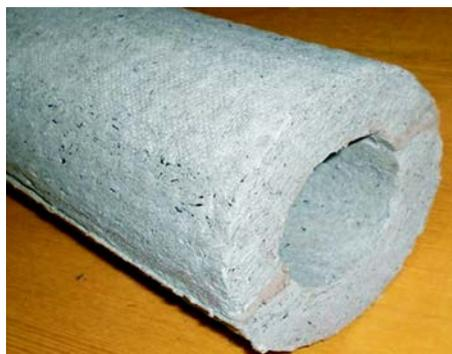
**Рис. 2.** Общий вид цилиндрических скорлуп, полученных методом жидкостной фильтрации из коротких базальтовых супертонких волокон
