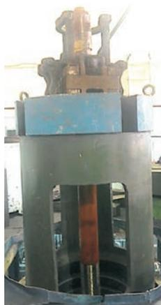
**Рис. 6.** Общий вид стенда УС-600 при испытании на растяжение стеклопластиковой оболочки насосно-компрессорной трубы
