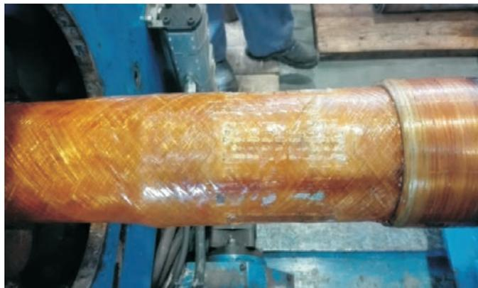
**Рис. 10.** Зона захвата спайдера после испытания насосно-компрессорной трубы крутящим моментом 9540 Н·м
