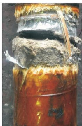
**Рис. 7.** Фрагмент насосно-компрессорной трубы после разрушения стеклопластиковой оболочки при осевой нагрузке в 48 тс на стенде УС-600
