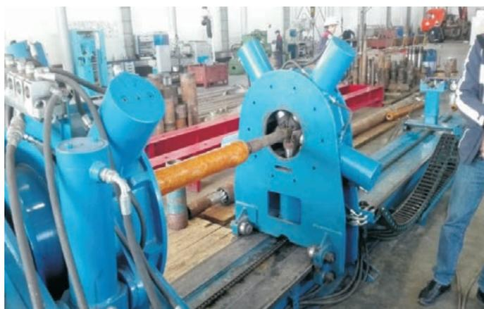
**Рис. 9.** Общий вид испытаний крутящим моментом стеклопластиковой оболочки насосно-компрессорной трубы на стенде СТС-2500
