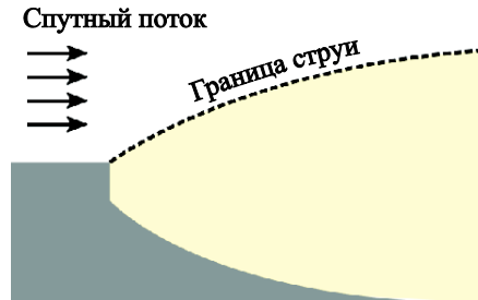
Рис. 2. Схема взаимодействия струи со спутным потоком в окрестности центрального тела
