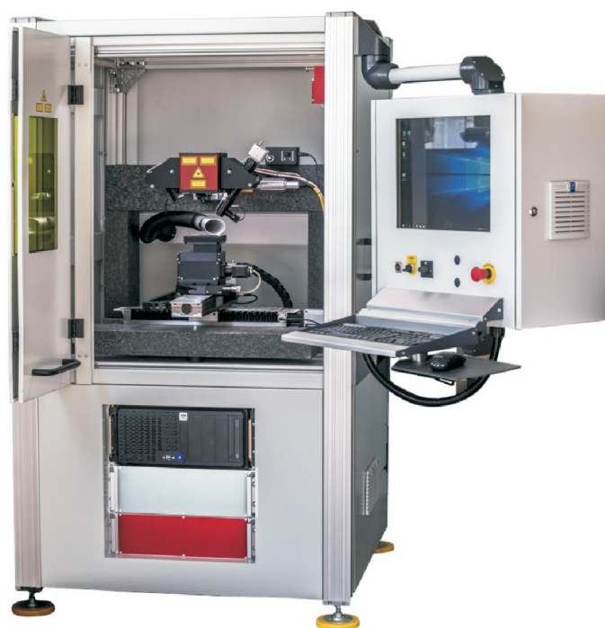
Рис. 2. МикроСЕТ — система прецизионной лазерной микрообработки материалов электронной техники
