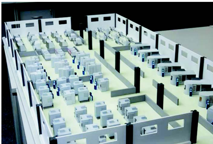
Рис. 6. Макет механообрабатывающего производства, выполненный на базе промышленного конструктора, изготовленного из ABS-пластика (изображение — по материалам электронного ресурса — сайта компании «Производственные решения»)
