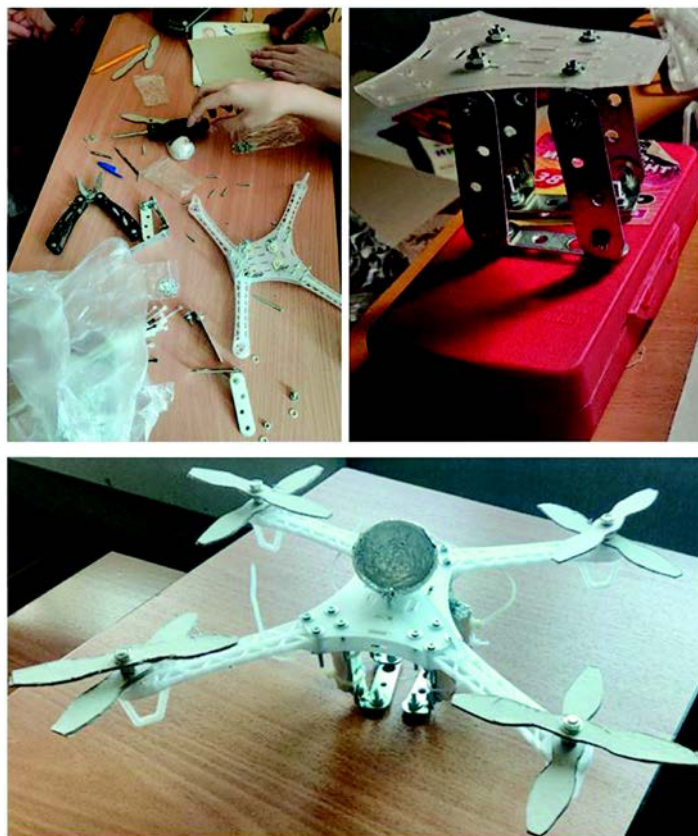
Рис. 4 (окончание). Прототипирование в порядке сквозной разработки: сборка физического прототипа, физический прототип спускаемого аппарата для проведения исследований на поверхности в рамках разработки РКС для исследования Титана
