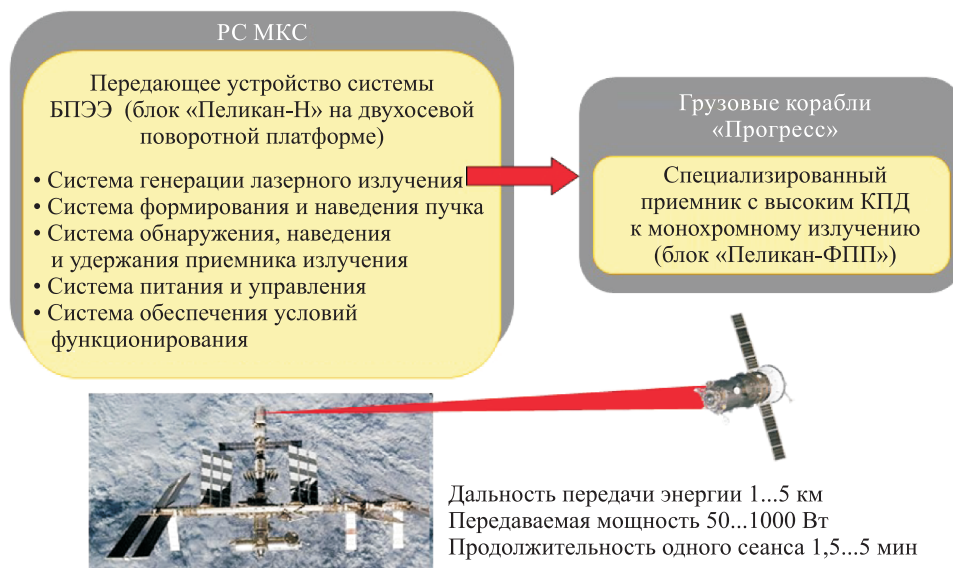
Рис. 1. Схема размещения научной аппаратуры «Пеликан» для проведения космического эксперимента по БПЭЭ
