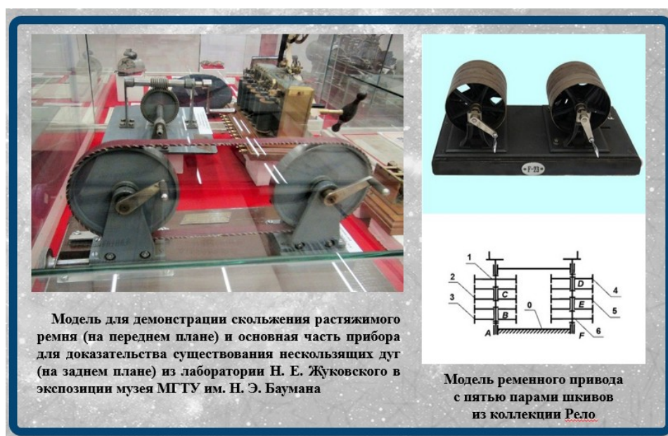
Рис. 3. Модели из лаборатории Н.Е. Жуковского (слева), а также модель Рёло (справа), связанные с передачей момента и вращения с помощью ременной передачи (из экспозиции музея МГТУ им. Н.Э. Баумана)
