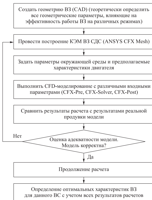
Рис. 2. Алгоритм создания математической модели воздухозаборника
