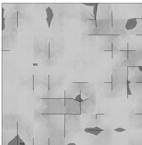
Рис. 1. Пятна фактического контакта на шероховатой поверхности меди при номинальном давлении P = 25 МПа
