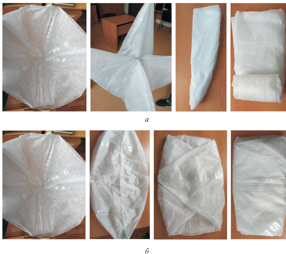
Рис. 3. Процесс укладки аэродинамического устройства
