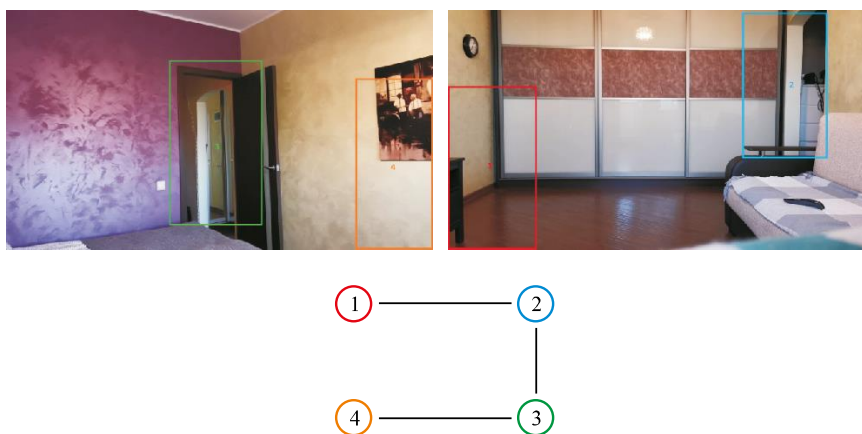
Рис. 3. Пример топологического графа межкамерного взаимодействия: 1 — зона выхода из поля наблюдения камеры I; 2 — зона выхода из поля камеры I в камеру II; 3 — зона входа из поля камеры I в камеру II; 4 — зона выхода из поля наблюдения камеры II
