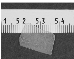
Рис. 1. Прозрачный образец композита опал-диоксид циркония-углерод. Толщина пластинки 0,7 мм
