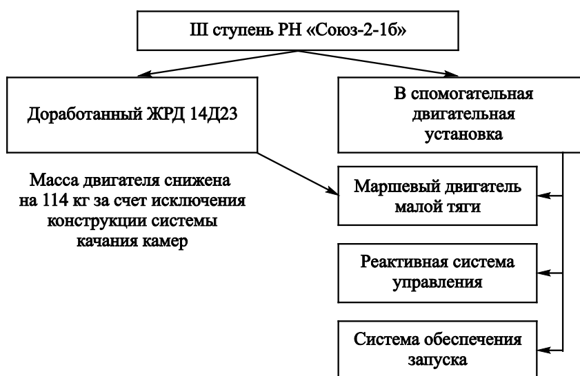
Рис. 1. Блок-схема вспомогательной двигательной установки в составе III ступени РН «Союз-2-1б»
