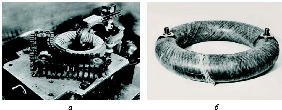
Рис. 1. Общий вид торонамоточного станка СНТ-2А с системой управления от ЧКМ (а) и характер разрушения стеклопластикового тороидального баллона (б)
