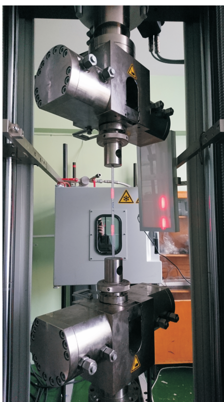
Рис. 4. Испытание стержня на сжатие на установке Zwick/Roell Z100
