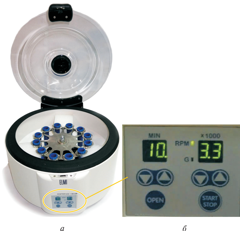
Рис. 7. Настольная лабораторная центрифуга CM-6M (ELMI): а — общий вид; б — дисплей
