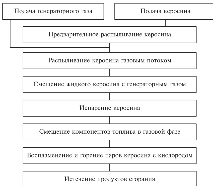
Рис. 1. Основные стадии рабочего процесса в камере сгорания жидкостного ракетного двигателя
