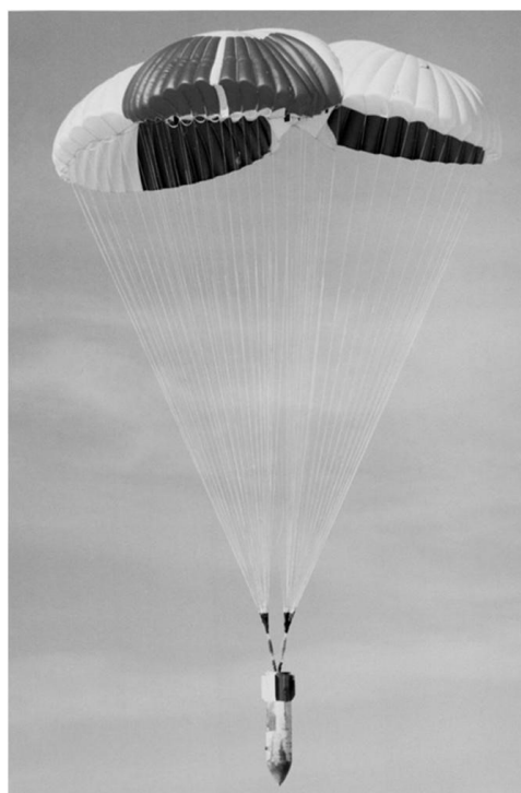
Рис. 6. Парашютная система с формой куполов, напоминающих лист клевера
