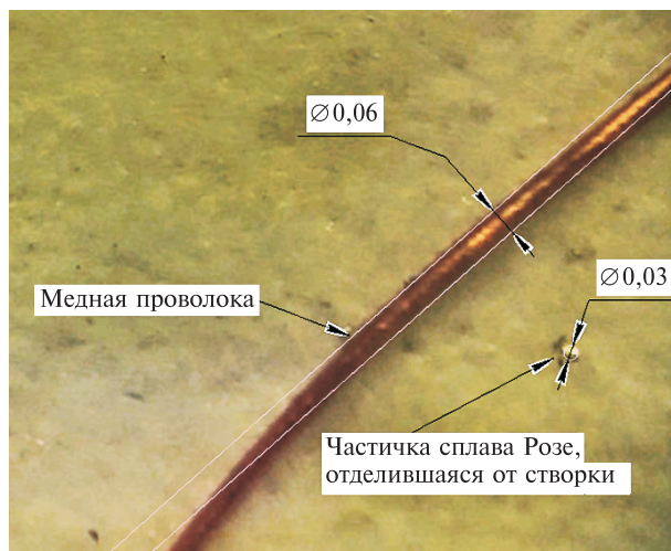
Рис. 8. Отделяющиеся от контакта на створке при раскрытии размеры частиц сплава Розе и частиц медной проволоки
