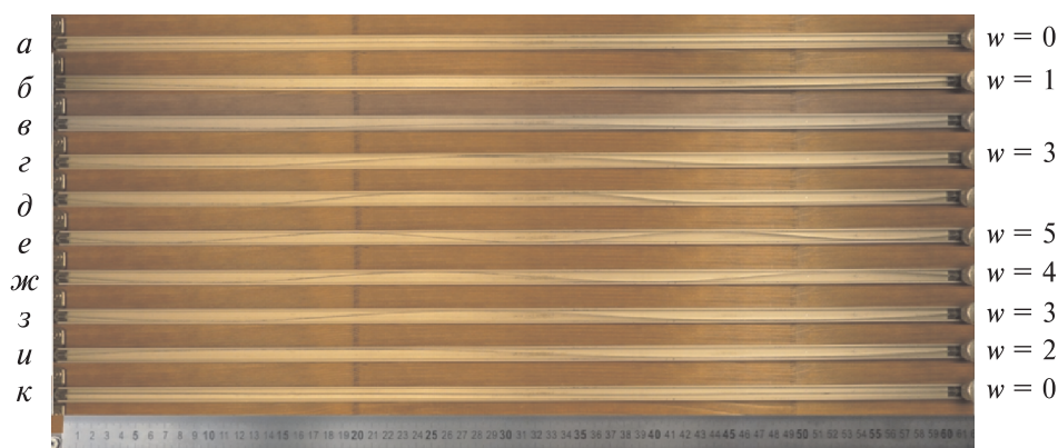
Рис. 9. Стальной стержень с шарнирами на концах при нагружении и последующем разгрузении:
