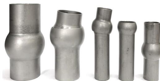
**Рис. 8.** Образцы деталей, полученные деформированием с применением эластичных и твердых сред
