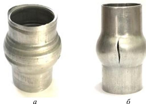
**Рис. 7.** Образцы деталей с дефектами: потеря устойчивости трубчатой заготовки (а), разрыв материала (б)
