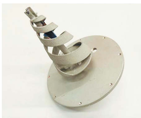
Рис. 4. Прототип антенны, выполненный методом 3D-печати
