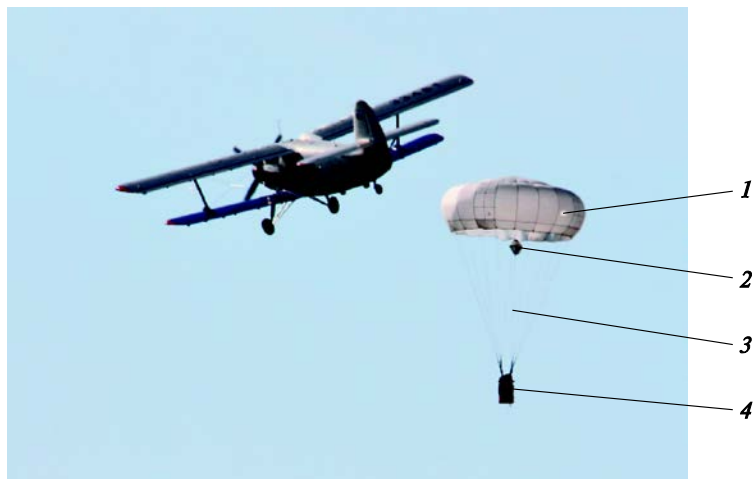
Рис. 18. Макетная парашютная система при F_{\text{п}} = 25 \text{ м}^2 :
