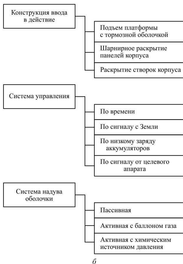
Рис. 2 (окончание). Состав автономного модуля увода КА CubeSat: б — варианты реализации основных подсистем устройства увода КА CubeSat
