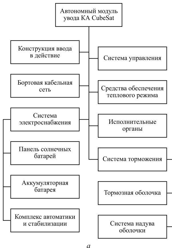
Рис. 2 (начало). Состав автономного модуля увода КА CubeSat:
