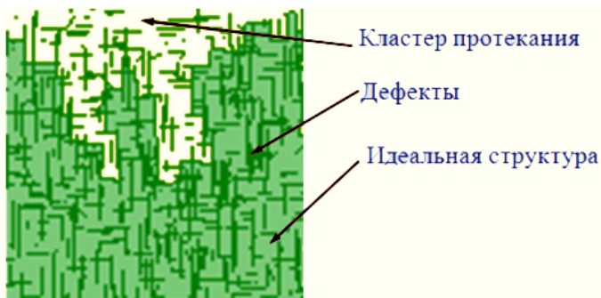
Рис. 4. Моделирование расположения дефектов в структуре сверхпроводника и протекания по нему сверхпроводящего тока
