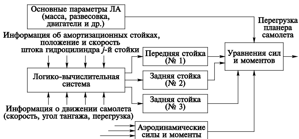
Рис. 6. Укрупненная структурная схема математической модели движения самолета типа Ил-114 на этапах разбега-пробега
