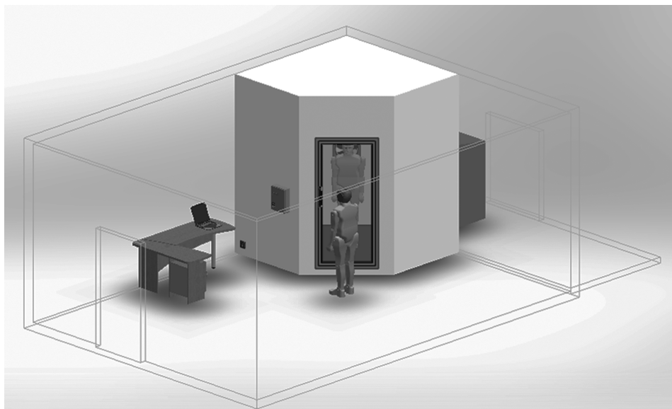
Рис. 10. Внешний вид предлагаемой криотерапевтической установки в помещении (оператор проводит процедуру, пациент находится внутри камеры, его обдувают воздушные струи вентиляторов; визуальный контроль проводится через стеклянную дверь, контроль температуры — по пирометру, установленному внутри кабины); холодильная установка располагается снаружи
