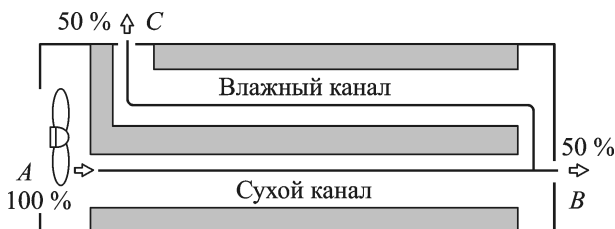
Рис. 2. Способ регенеративного косвенного испарительного охлаждения воздуха
