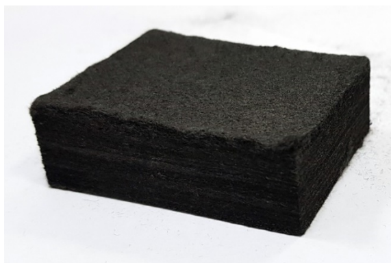
Рис. 1. Общий вид материала на основе углеродного войлока
