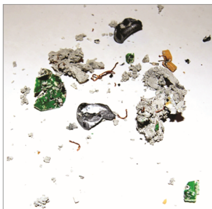
Рис. 10. Фотография электронной сборки после испытаний
