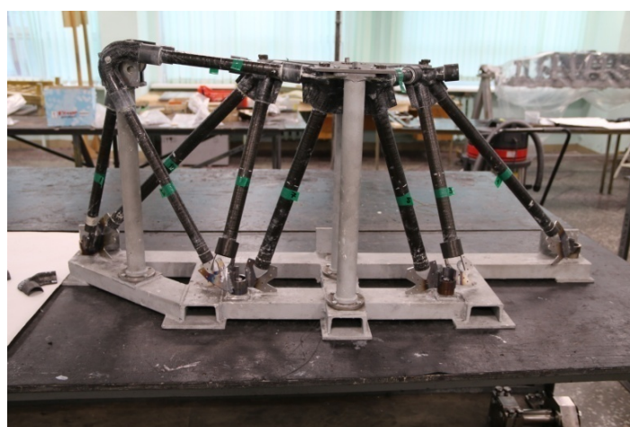
Рис. 5. Фрагмент рамы на стапеле для сборки
