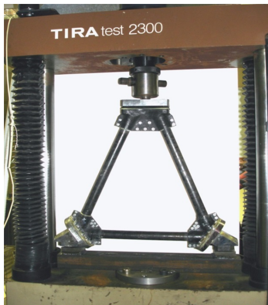
Рис. 1. Трапеция, установленная в приспособление для испытаний
