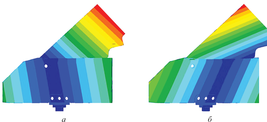
Рис. 6. Формы первых двух тонов колебаний руля: а — первый тон колебаний, f = 70 Гц; б — второй тон колебаний, f = 100 Гц
