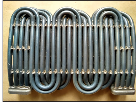
Рис. 3. Модифицированный воздухо-воздушный теплообменник из четырех цилиндрических трубок увеличенного диаметра 6,0 \times 0,35 мм, установленный на корпусе камеры сгорания
