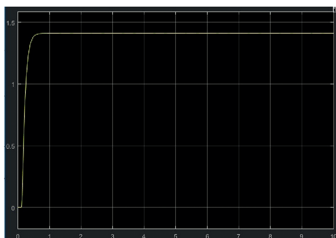
Рис. 6. Переходной процесс по тяге
